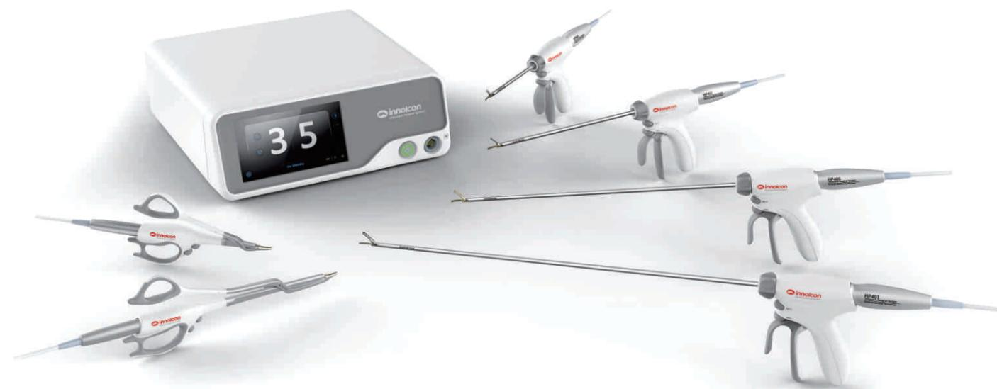
Il sistema chirurgico ad ultrasuoni (bisturi ad ultrasuoni) è un dispositivo chirurgico che utilizza l'energia ad ultrasuoni per ottenere dissezione, taglio, sintesi e coagulo dei tessuti molli. Può essere utilizzato per tagliare e sigillare vasi fino a 5 mm di diametro. Ha un ampio campo di applicazioni nella chirurgia aperta ed endoscopica.
