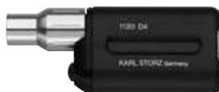
**11301 D4 Sorgente luminosa LED a batterie per endoscopi,** con filettatura rapida, luminosità > 110 lm / > 150 klx, durata > 120 min., peso operativo ca. 150 g, disinfezione esterna con salviette
