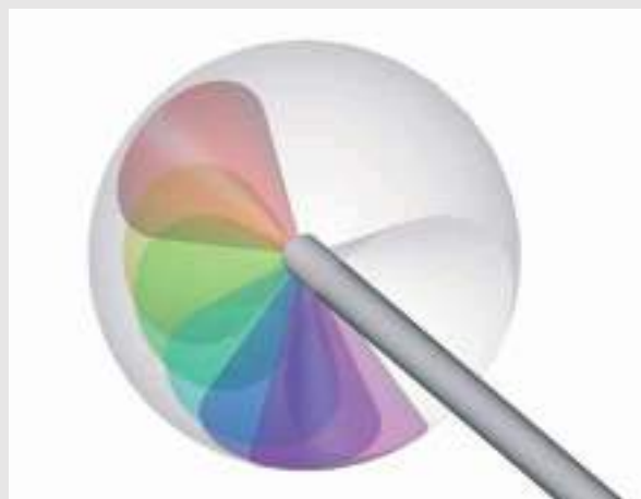
ENDOCAMELEON® con direzione della visuale variabile, visione isometrica
