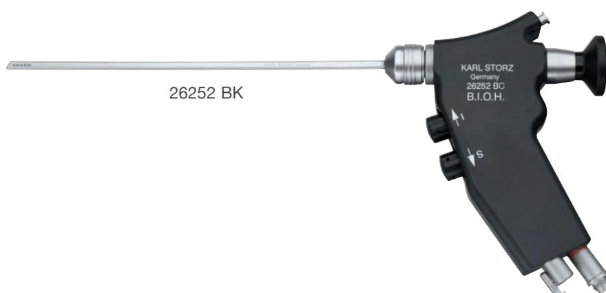
26252 BK **Isteroscopio compatto B.I.O.H.®** sec. BETTOCCHI®, sistema ottico HOPKINS® 30°, misura 4 mm, con canale operativo per strumenti chirurgici semirigidi da 5 Charr., con valvola di aspirazione e di irrigazione per applicazioni a flusso singolo o continuo, impugnatura lunga
